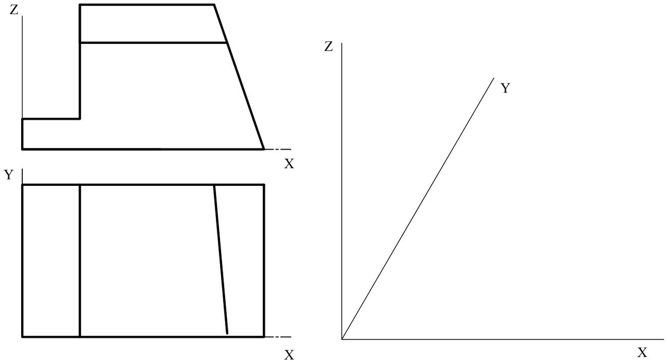
**3.2.-** Dibujar la perspectiva del sólido representado en sistema diédrico conociendo el punto de vista, **V**, la línea de tierra, **LT**, y la línea de horizonte.
