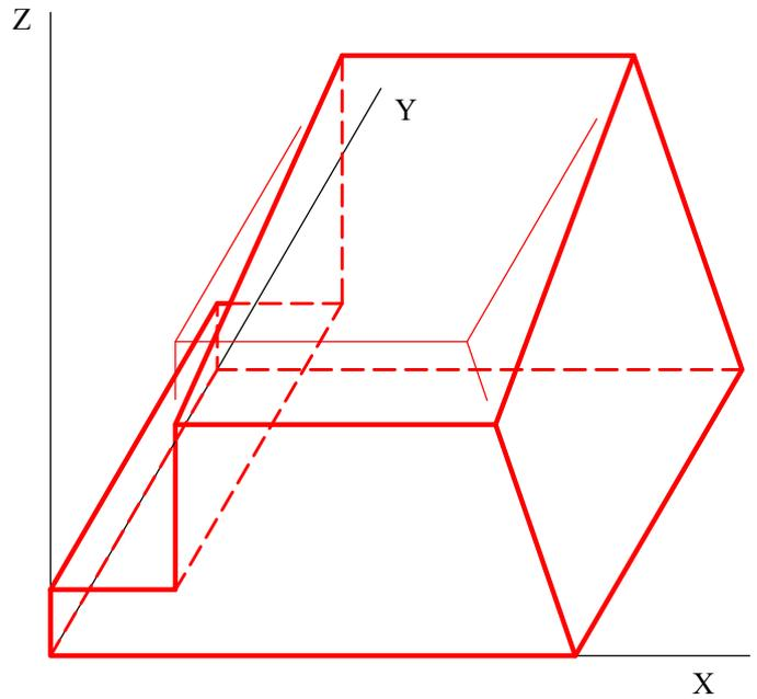
**3.2.-** Dibujar la perspectiva del sólido representado en sistema diédrico conociendo el punto de vista, V, la línea de tierra, LT, y la línea de horizonte.
