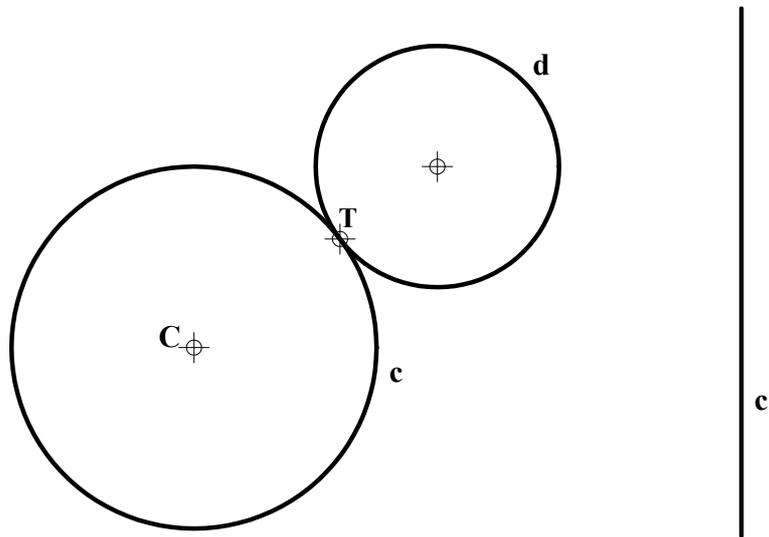
**1.2.** Hallar una circunferencia tangente a las tres dadas,  $c_1$ ,  $c_2$  y  $c_3$ . Indicar los puntos de tangencia. Justificar la construcción empleada.
