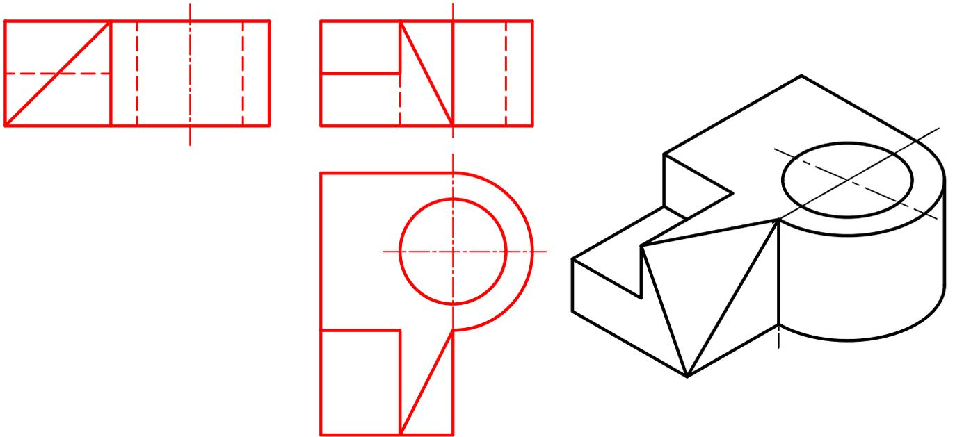
**4.2.-** Completar, sin seccionar, el alzado de la figura dada y acotarlo para su correcta definición dimensional.
