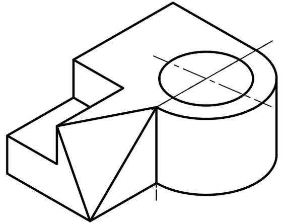
**4.2.-** Completar, sin seccionar, el alzado de la figura dada y acotarlo para su correcta definición dimensional.
